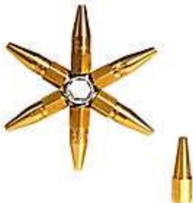
Elles permettent de **changer le débit des gaz** en fonction de **l'épaisseur, de la nature du métal et de la position de soudage**. C'est le nombre de litres d'acétylène consommés pendant **une heure d'utilisation** du chalumeau. Ce chiffre figure sur la buse.
