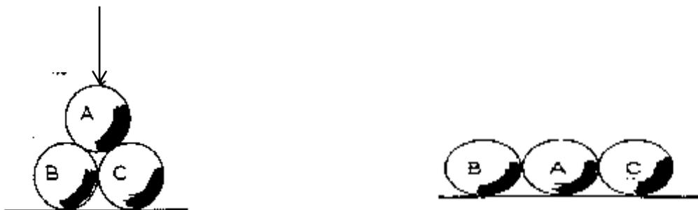
Sous l'action d'une force, le grain A s'intercale entre B et C. Les dimensions de l'ensemble ont changé: La hauteur diminue, la longueur augmente. Exemple: Le martelage.
