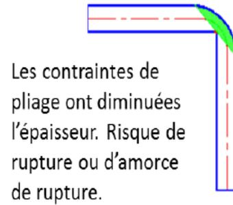
Les contraintes de pliage ont diminuées l'épaisseur. Risque de rupture ou d'amorce de rupture.
