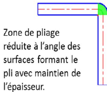
Zone de pliage réduite à l'angle des surfaces formant le pli avec maintien de l'épaisseur.
